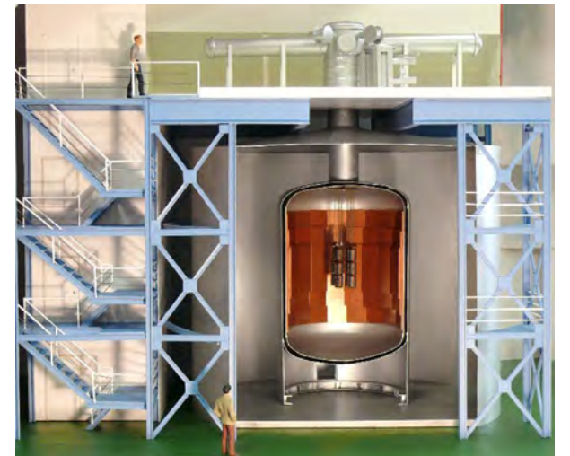
▲ Криогенная установка GERDA в подземной лаборатории Гран-Сассо, Италия
