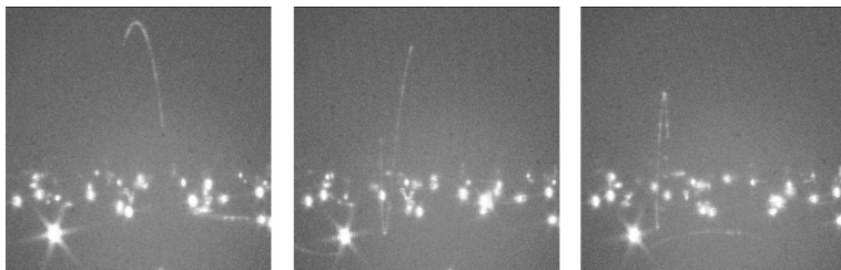
Рис. 2. Видеосъёмка выбивания макрочастицы снизу, вид сбоку: экспозиция 0,04 с, размер видимой области 5 \times 5 мм. Ряд светящихся точек в центре кадра — плазменно-пылевая структура, светлые линии — траектория выбитой макрочастицы
