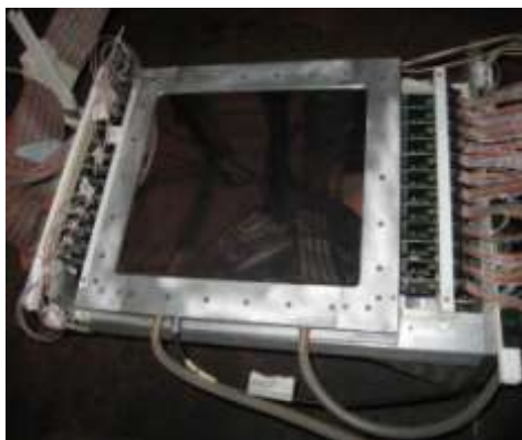
Рис.3. Пучковые пропорциональные камеры.
