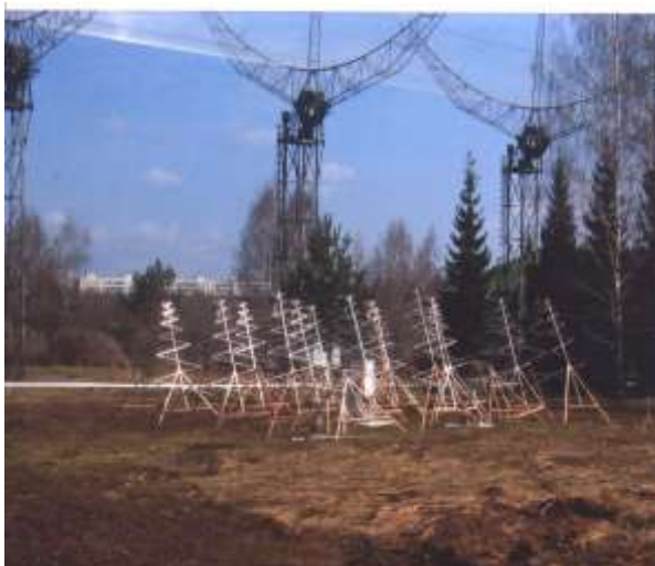
Рис. 4. В рамках настоящего проекта будут начаты новые наблюдения Луны с целью поиска всплесков черенковского радиоизлучения в диапазоне метровых волн. С этой целью будет изготовлен 16-элементный антенный модуль, служащий экспериментальным прототипом базового модуля не только для нового радиоастрономического детектора нейтрино экстремально высоких энергий, но и прототипом радиотелескопа метровых волн нового поколения, использующего новейшие
