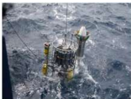
Рис. 1а. На фото: экспериментальный действующий макет глубоководного МСЗ «Баклан», размещенный на комплексе CTD-Rosette вместе с акустическим профилографом скорости течений ADCP, начало ускоренного погружения на стартовую глубину 1,5 км, май 2009г
