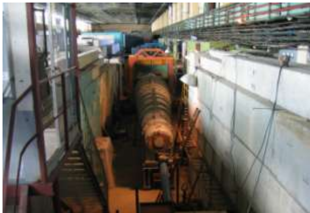
Рис.1. Установка ОКА. На переднем плане - распадный объём с охранной системой. На заднем плане – большой спектро- метрический магнит для измерения импульсов вторичных частиц.
