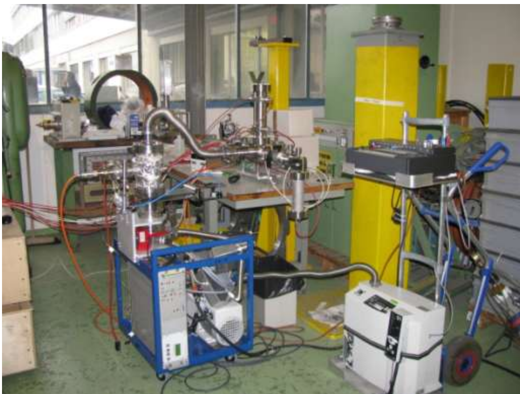
Рисунок 9.1 —Стенд лабораторных испытаний измерителя в ЦЕРН.
