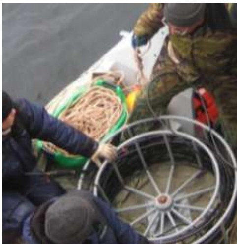
Рис. 2 Экспериментальный образец гидроакустической станции на базе широкоапертурной (порядка 150 метров) кабельной антенны для долговременного мониторинга акустического поля на морском полигоне.
