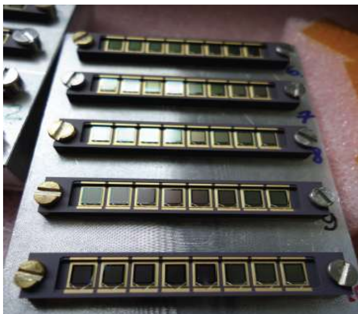
Рисунок 27 - Матрица МЛФД фирмы КЕТЕК, использовавшаяся в тестах на пучках пионов ускорителя SPS.
