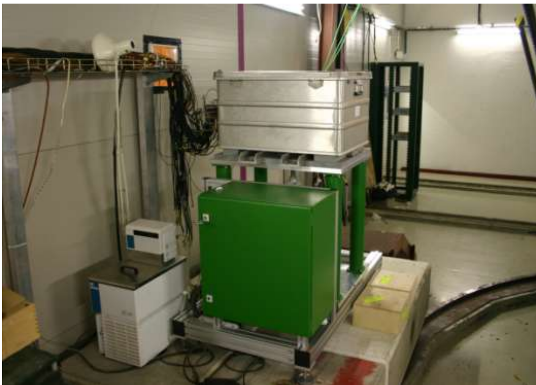
Рисунок 16 - Модернизированная установка для исследования радиационных свойств кристаллов, облученных на канале Н4.
