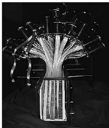
Рис. 5. а — Схема слоя ПВК (слева направо: свинцовая пластина, ряд пластиковых волокон, сцинтилляционная пластина со спектросмещающим волокном); б и в — фотографии ячейки, состоящей из 20 таких слоев, и всего прототипа 5 \times 5 ячеек соответственно.
