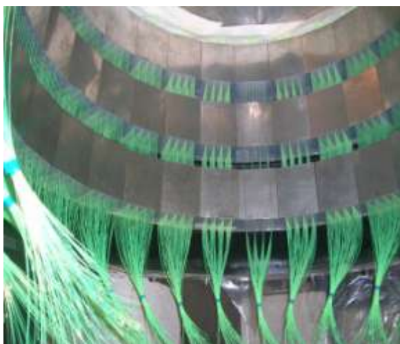
Рис.1. Установка ОКА. На переднем плане - распадный объём с охранной системой. На заднем плане – большой спектро- метрический магнит для измерения импульсов вторичных частиц.
