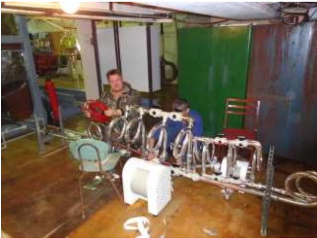
На фотографиях представлены отдельные узлы системы для транспортировки жидкометаллической галлиевой мишени между химико-технологической системой экстракции германия ГГНТ и двухзонной облучательной установкой
