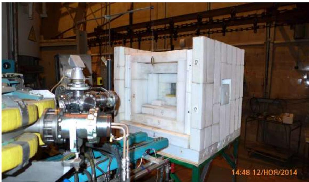
Рисунок 7.2 - Фотонейтронный источник в процессе монтажа на ускорителе ЛУЭ-8-ИЯИ РАН.
