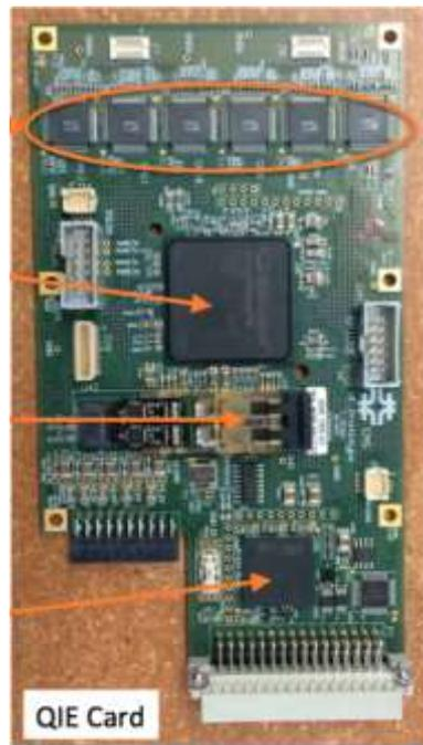
Рисунок 4.1.9 – QIE-карта новой передней считывающей электроники торцевого и баррельного адронных калориметров. Сверху вниз стрелками обозначены 6 высокоскоростных АЦП (ещё 6 находятся с другой стороны), многофункциональный чип Igloo2, оптический передатчик VTTX-2, мостовой чип.
