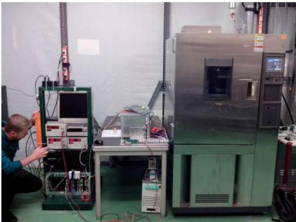
Рисунок 4.1.12 - Климатическая камера для ускоренного старения электроники и задняя считывающая электроника.
