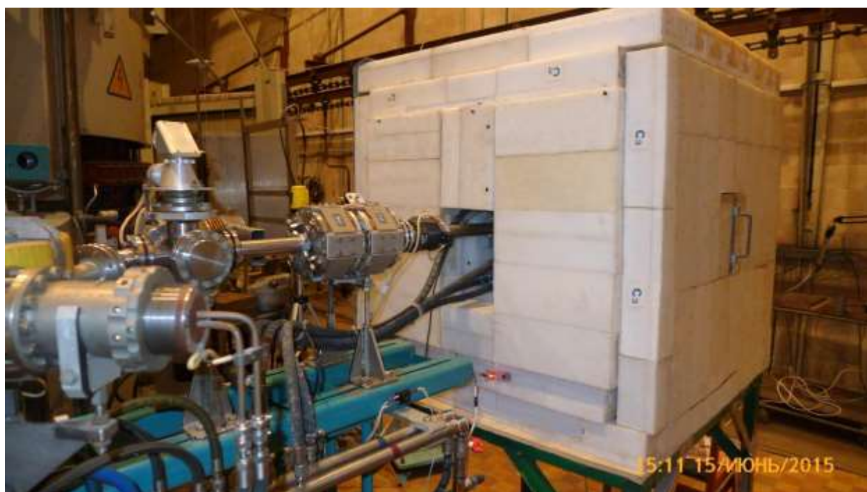
Рисунок 2.6 - W-Be-фотонейтронный источник на пучке электронов ускорителя ЛУЭ-8-5 ИЯИ РАН
