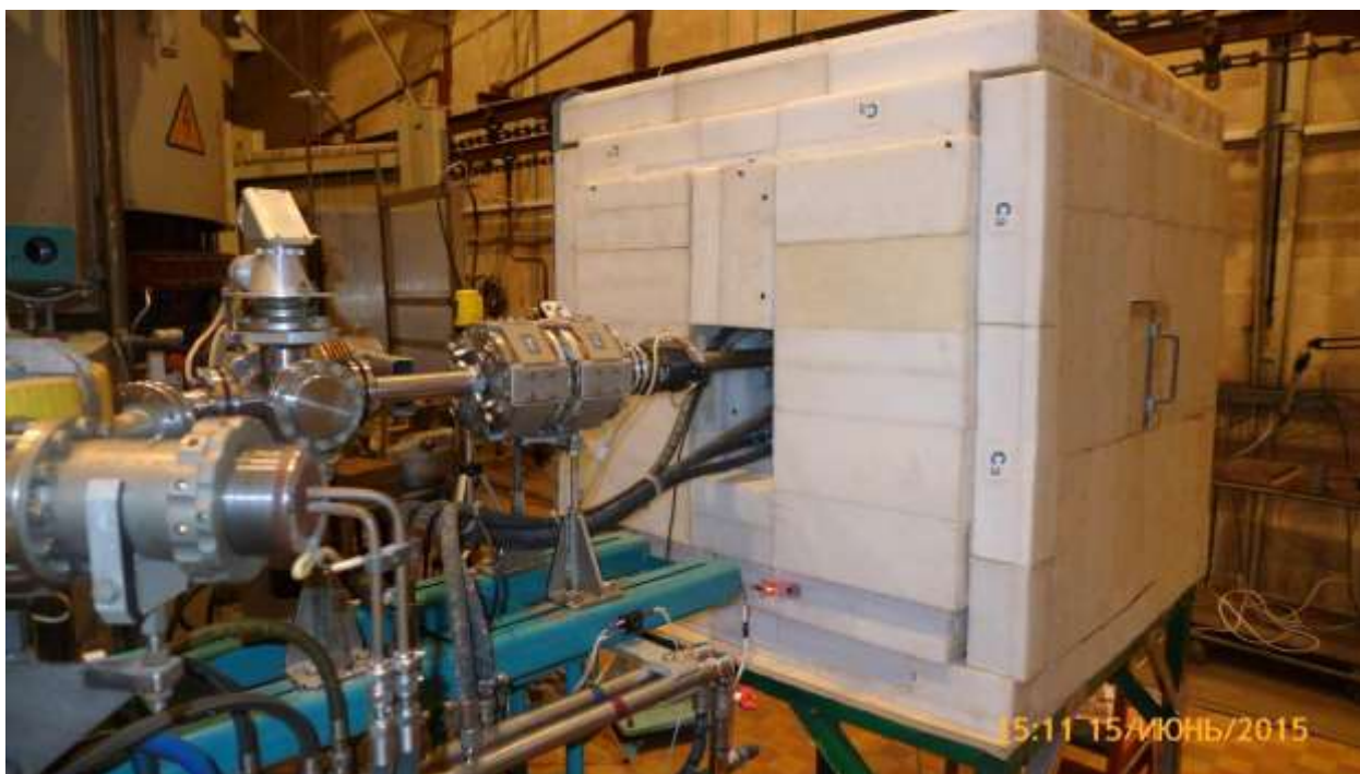
Рисунок 2.12 - W-Be-фотонейтронный источник на пучке электронов ускорителя ЛУЭ-8-5 ИЯИ РАН
