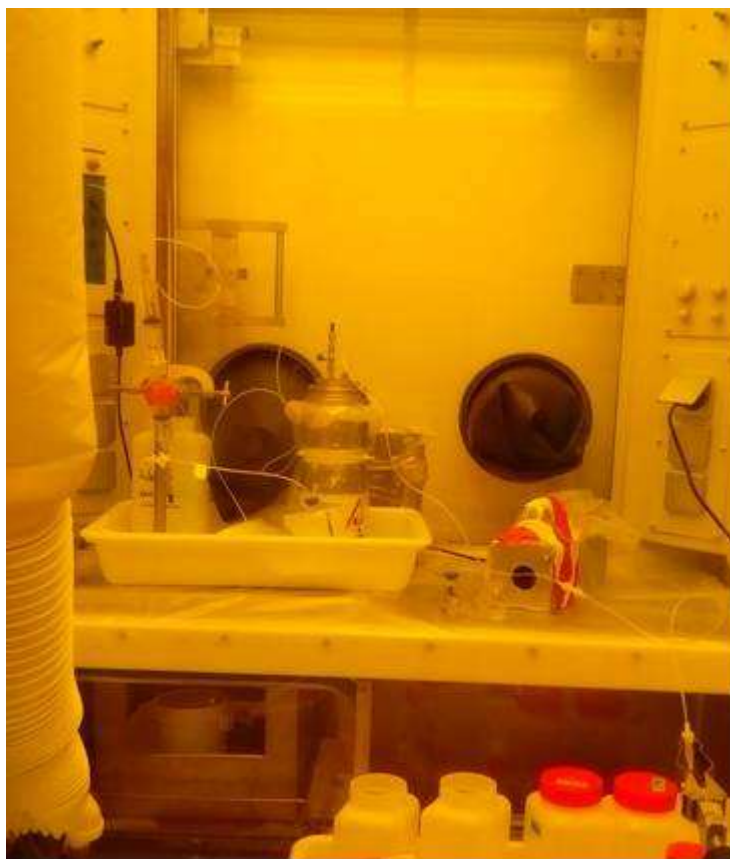
Рисунок 2. Зарядка генератора в вольфрамовом контейнере в горячей камере центра ARRONAX.
