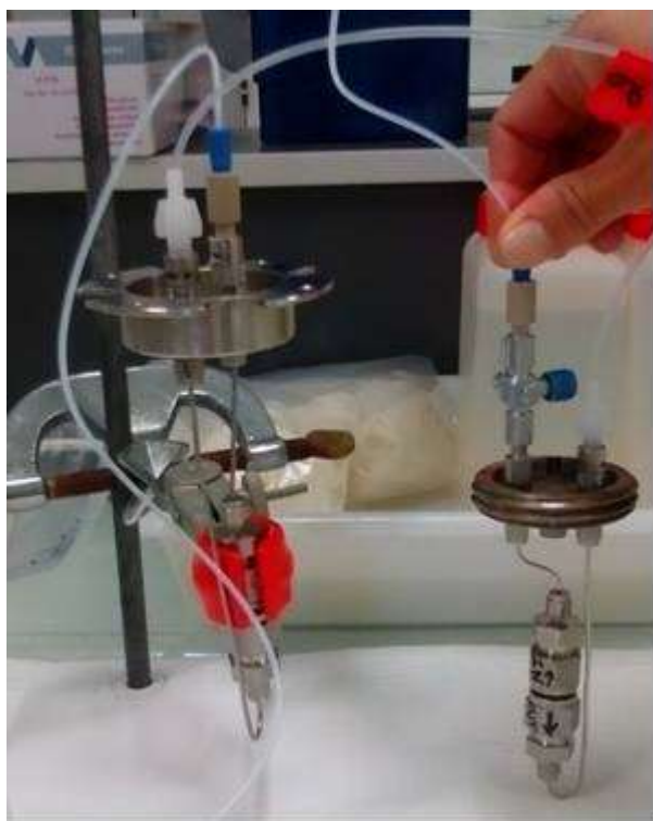
Рисунок 1. Колонки для медицинских генераторов рубидия-82 российского (слева) и французского (справа) образцов.
