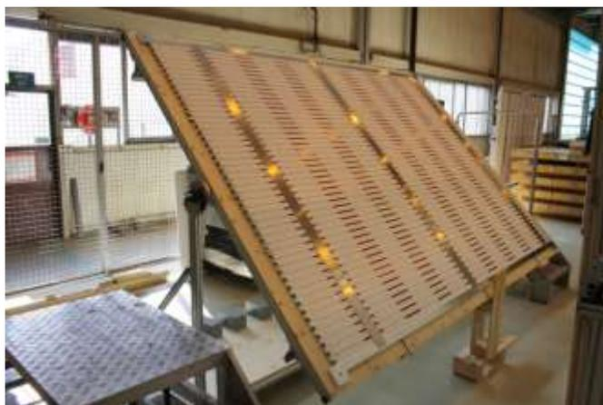
Рисунок 3 Первый модуль детектора Baby-MIND, смонтированный в ЦЕРНе.
