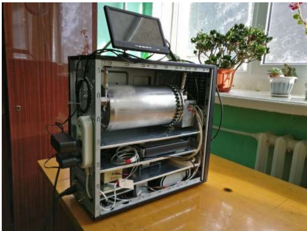
Рис. 4.2.4.4 Вид внутреннего пространства и размещения узлов Rn-монитора
