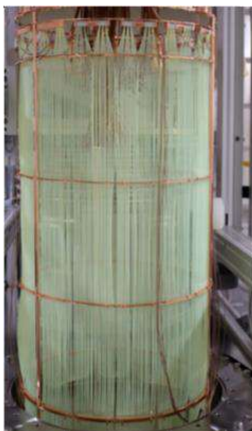
Рисунок 5.1.2 - Система светособирающих волокон
