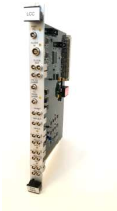
Рисунок 1.1.3 - Модуль управления лазером и разветвитель сигнала синхронизации в стандарте VME (LCC)
