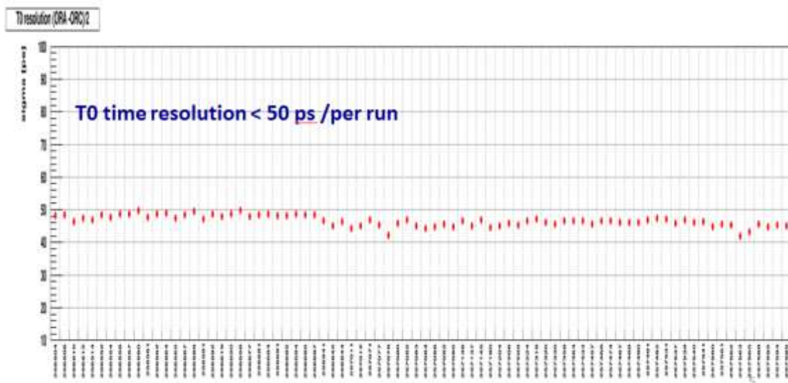
Рисунок 1.1.2.4. - Тренд временного разрешение детектора T0 для протон-протонных столкновений при энергиях в системе центра масс \sqrt{s} = 13 TeV в зависимости от рана
