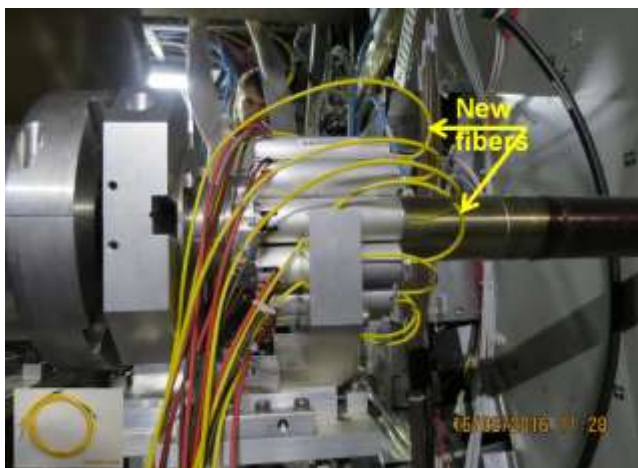
Рисунок 1.1.2 - Детектор T0-A с новыми короткими оптическими кабелями
