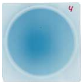
Рисунок 1.1.9 - Пленка GafchromicMD-V2-55 на выходе коллиматора защиты в процедурной (4) и на входное окно фантома(5)
