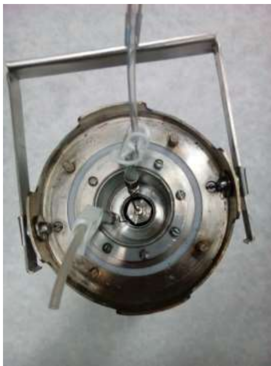
Рисунок 2.2.5 Защитный свинцовый контейнер (ГР-02) с помещенной в него увеличенной колонкой №1 (вид сверху).
