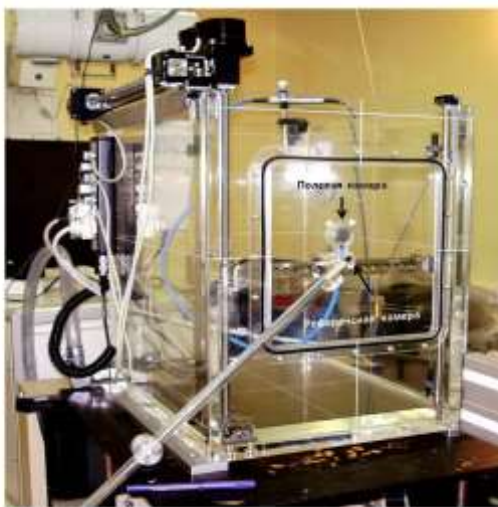
Рисунок 1.1.2 Анализатор MR3-PT41029. На фото видно расположение референсной ионизационной камеры на штанге с держателем, водный фантом и полевую ионизационную камеру в креплении позиционера водного фантома.
