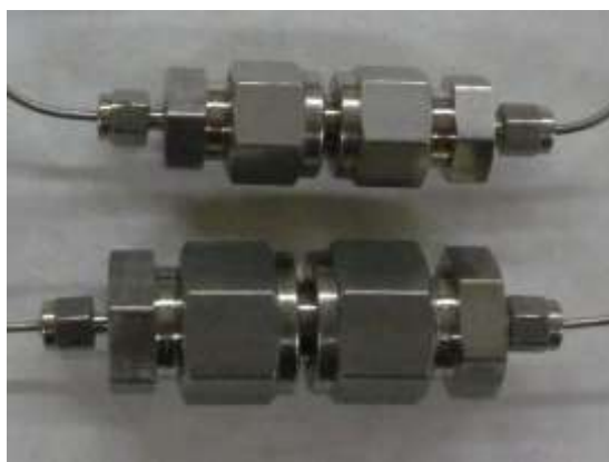
Рис. 1. Внешний вид колонок (сверху – старая конструкция, внизу – новая конструкция).
