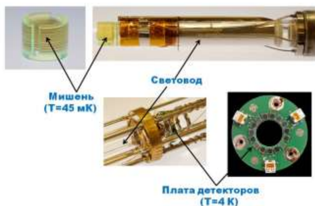
Рис. 1. Элементы активной поляризованной мишени
