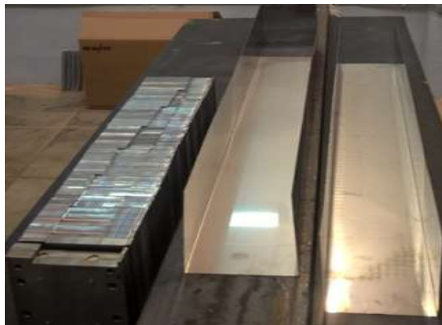
Рис. Основные компоненты для изготовления супермодуля калориметра. Слева – сцинтилляционная пластина с канавкой для вклеивания спектросмещающего волокна.
