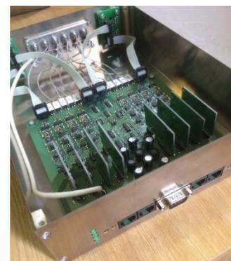
Рисунок 19. Образец материнской платы на 8 каналов. Один канал состоит из усилителя-формирователя, двух-порогового дискриминатора. Плата имеет 8 индикаторов сигнала, два логических сумматора (ИЛИ) на 4 канала и 16 парафазных выходов, рассчитанных на передачу сигналов 8 цифровых и 8 аналоговых по ethernet UTP-5E кабелю.
