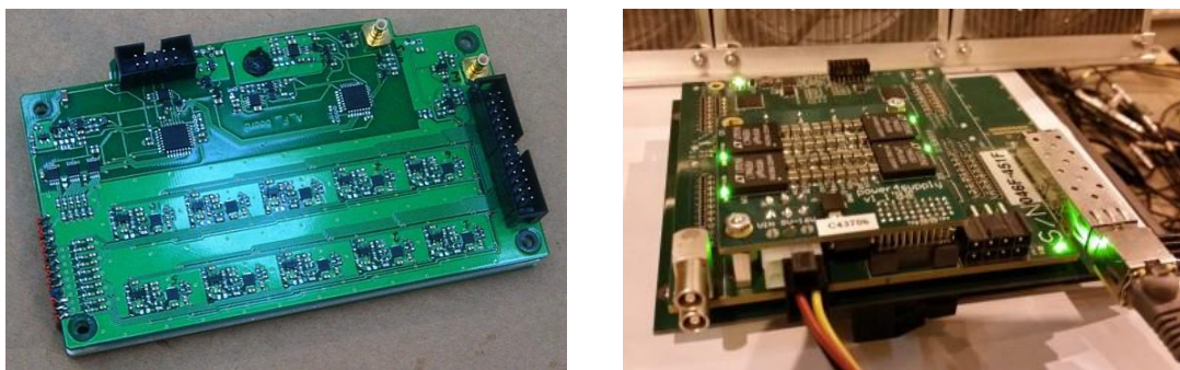
Рисунок 53. Слева — плата с аналоговой электроникой для считывания сигналов с 10 фотодетекторов в конце модуля калориметра СВМ. Справа — плата с АЦП (AFI Electronics ADC64s2).
