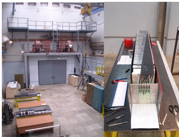
Рисунок 50. Участок для сборки модулей в ИЯИ РАН (слева) и процесс сборки модуля калориметра (справа).
