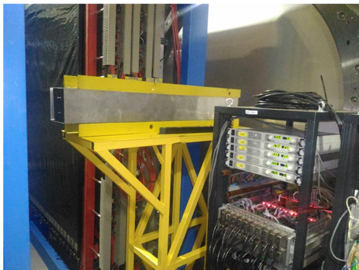
Рисунок 69. Расположение модуля адронного калориметра на BM@N, для проведения измерений на пучках ионов углерода, аргона и криптона.
