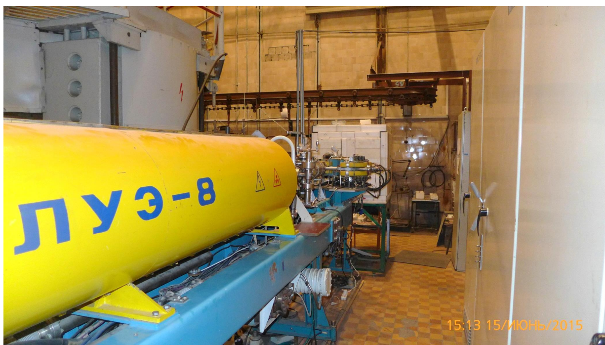
Рисунок 114. W-Be-фотонейтронный источник ИН-ЛУЭ ИЯИ РАН на пучке электронов ускорителя ЛУЭ-8-5
