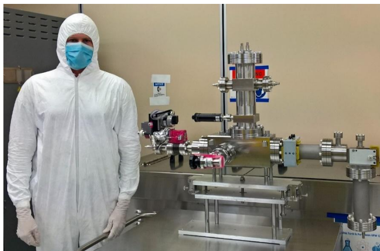
Рисунок 6 – Сотрудник Института с собранным измерителем формы сгустков в чистом помещении для сборки оборудования ускорителя FRIB MSU.
