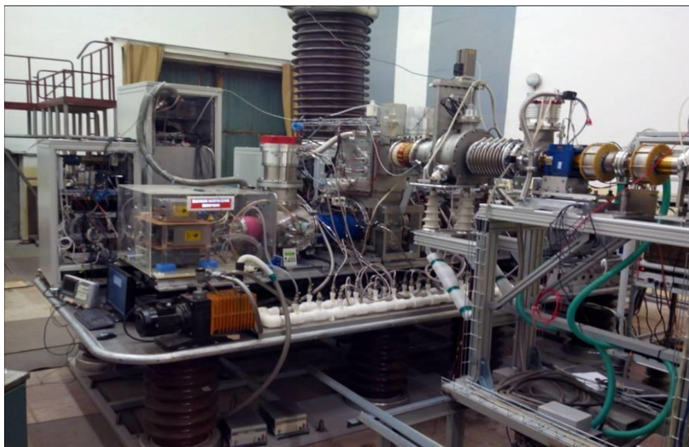
Рисунок 3 - Источник поляризованных и неполяризованных дейтронов и протонов, установленный в инжекторном помещении НУКЛОТРОНа ОИЯИ. Источник был создан и запущен в эксплуатацию в сотрудничестве с ИЯИ РАН.
