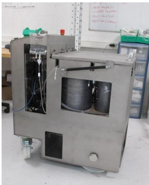
Рисунок 13. Инжекционная система (Франция) для элюирования из генератора рубидия-82 ГР-01 (ИЯИ РАН, Россия)
