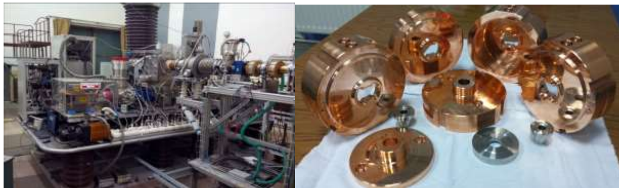
Рис.3. Источник поляризованных и неполяризованных дейтронов и протонов, установленный в инжекторном помещении НУКЛОТРОНа ОИЯИ.
