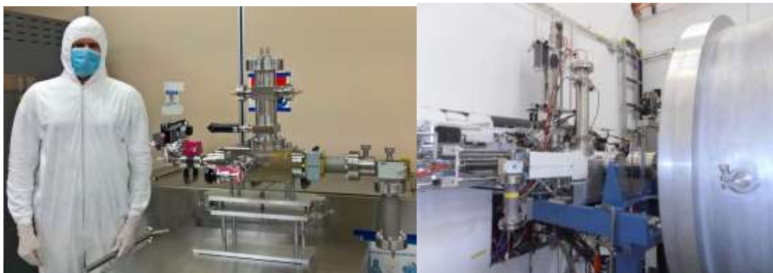
Рис. 5. Собраный измеритель формы сгустков в чистой комнате для сборки оборудования ускорителя FRIB MSU.
