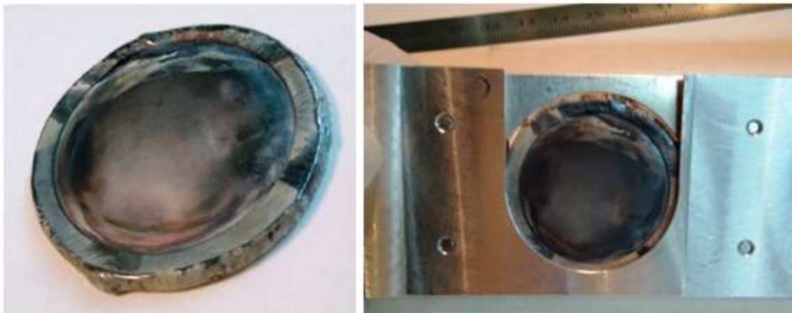
Рис. Изготовленный прототип ториевой мишени в ниобиевой оболочке (слева); тот же прототип в алюминиевом держателе, подготовленный для облучения пучком протонов (справа).
