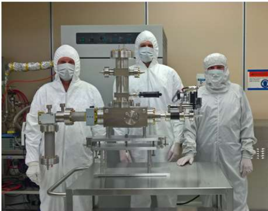
Рис. Сотрудники ИЯИ РАН с собранным и настроенным измерителем формы сгустков в специальном помещении для сборки вакуумного оборудования ускорителя FRIB MSU (январь 2018 года).
