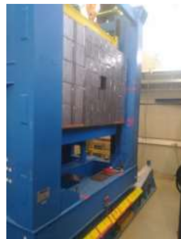
Рис.1. Фотография калориметра, установленного на BM@N на специальной платформе, которая позволяет перемещать калориметр весом около 17 тонн в плоскости, перпендикулярной пучку, для его калибровки на пучках ионов.
