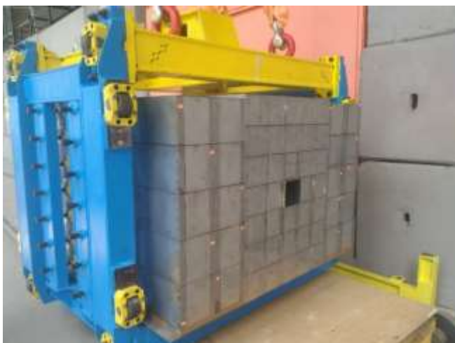
Рис.1. Фотография калориметра, установленного на BM@N на специальной платформе, которая позволяет перемещать калориметр весом около 17 тонн в плоскости, перпендикулярной пучку, для его калибровки на пучках ионов.
