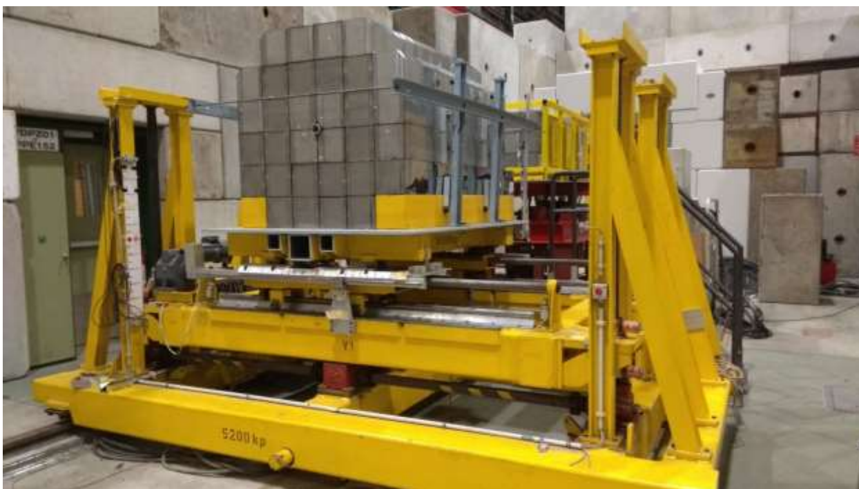
Рис.2. Модернизированный калориметр из 32 модулей общим весом 16 тонн установлен на специальной платформе для его перемещения во время процедуры калибровки.
