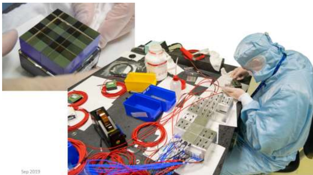
Рисунок 4. Сборка детектора FIT-T0C в чистой комнате класса 10000 в ЦЕРНе.
