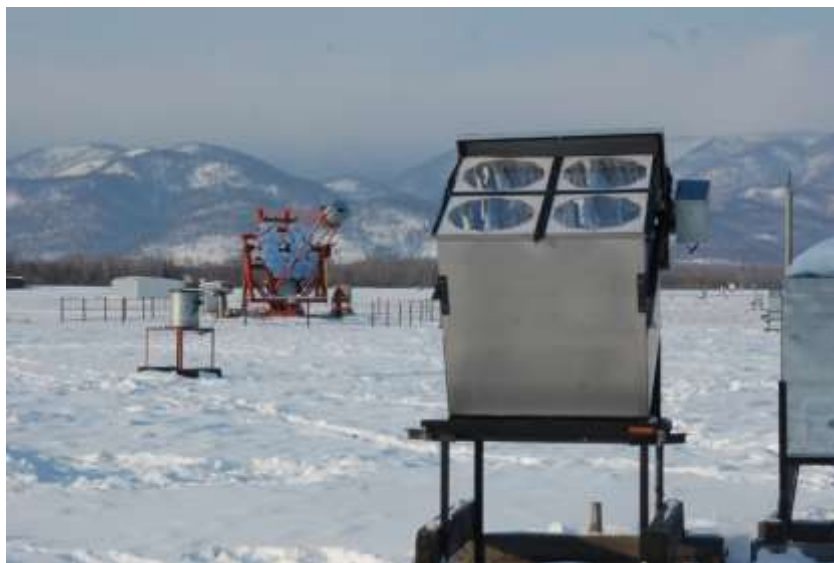
Рис.2. Один из черенковских атмосферных телескопов изображения TAIGA-IACR (слева) и одна из оптических станций черенковской широкоугольной установки TAIGA-HiSCORE (справа).
