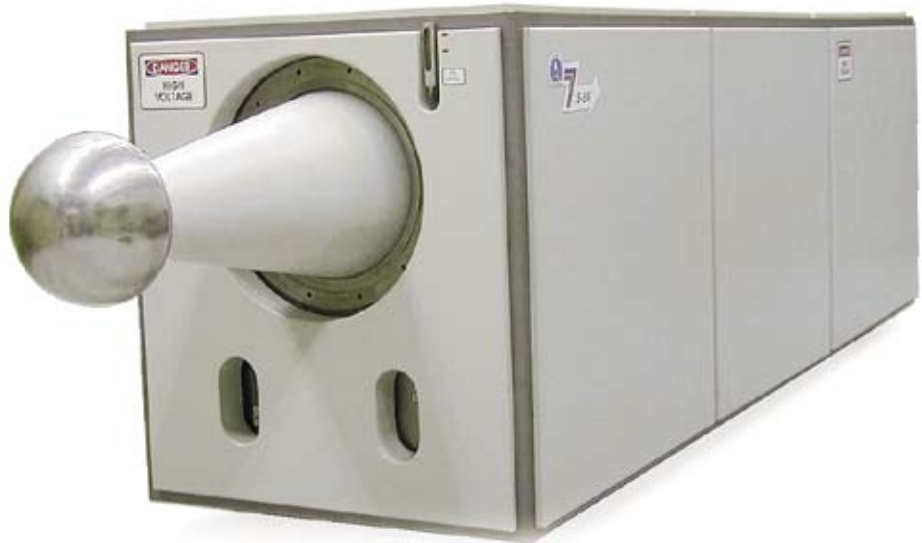
Генератор на SOS-диодах С5-Н (1 МВ, 3,5 кА, 60 нс, 1000 Гц).
