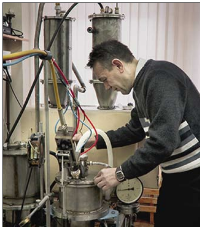
Установка для получения нанопорошков электровзрывом проволоочек.
