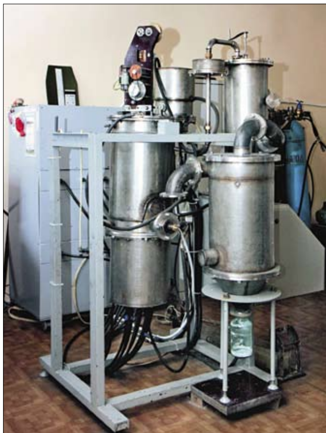
Установка для получения нанопорошков электровзрывом проволоочек.
