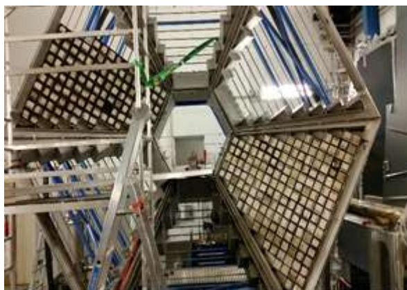
Рисунок 1. Секторы 3 и 6 калориметра ECAL в сборке из детекторных модулей на платформе установки ХАДЕС
