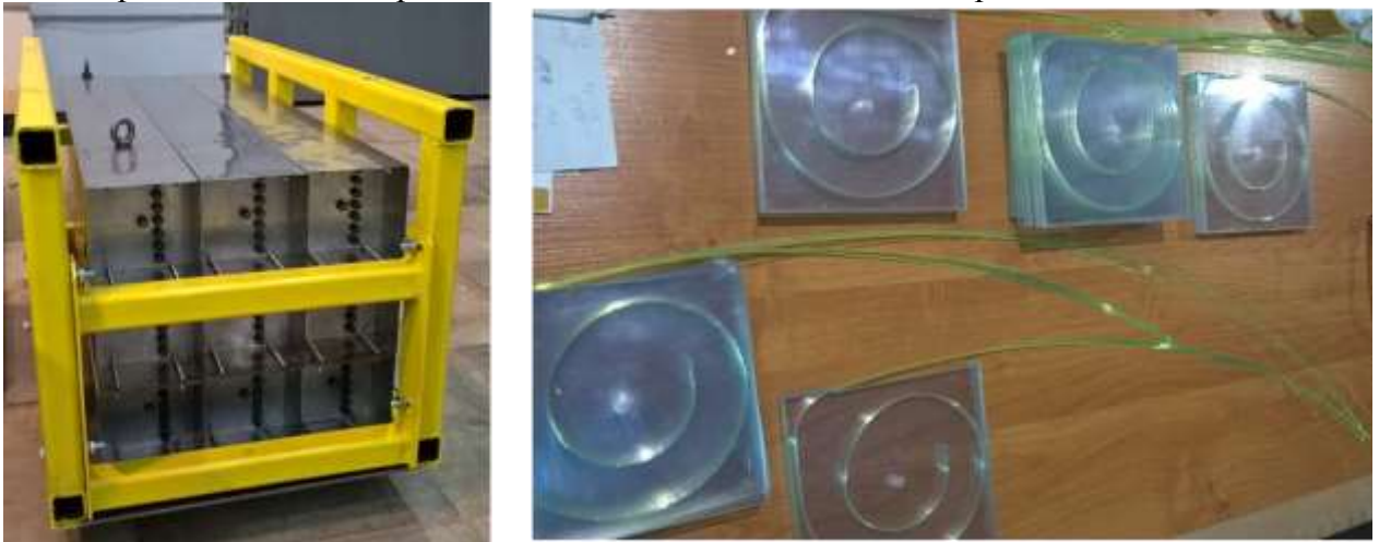
Рисунок 1. Слева - фото нескольких модулей адронного калориметра. Справа – фото активных элементов калориметра, сцинтилляторов и переизлучающих оптических световодов.
