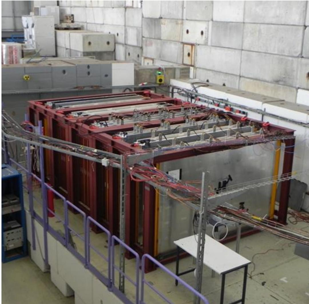
Детектор сэндвичного типа чередует 18 сцинтилляционных модулей и 33 стальных модуля.
