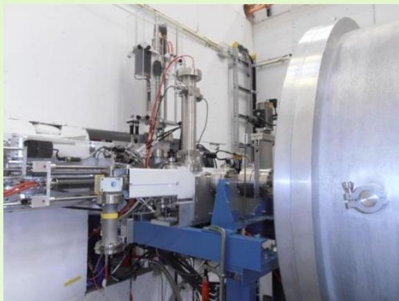
Испытания измерителя формы сгустков в GSI в канале инжекции UNILAC с пучком Ar<sup>9+</sup>, 1.4 MeV/u
