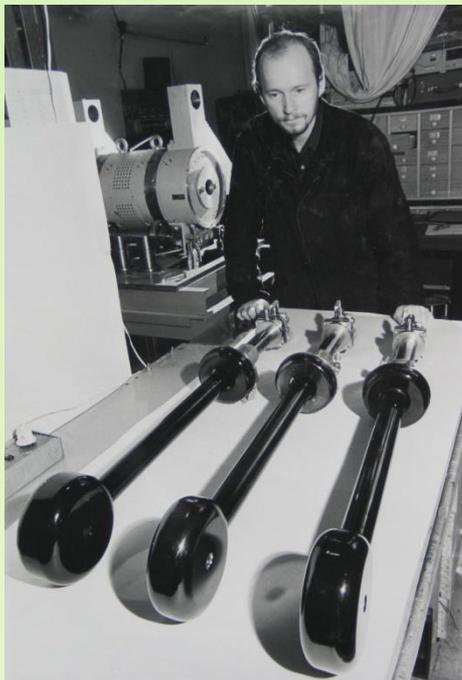
**Трубки дрейфа на заводе ЛЭЗ**
