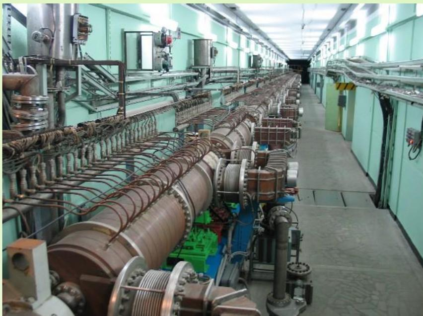
**Ускоряющие резонаторы основной части ускорителя**
