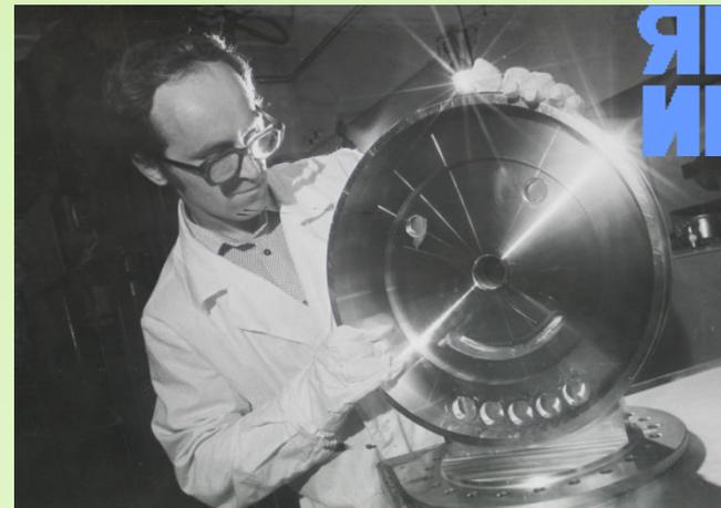
Модуль ускоряющей структуры
