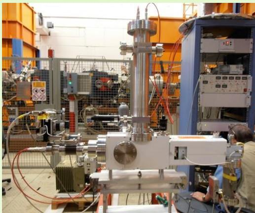
Испытания измерителя формы на стенде в GSI
