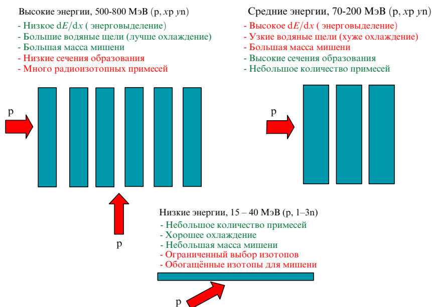
Рис. 1. (В цвете онлайн.) Преимущества и недостатки получения изотопов при облучении мишеней протонами разных энергий (стрелками указаны возможные направления пучка протонов, которым облучают мишени разной толщины).
