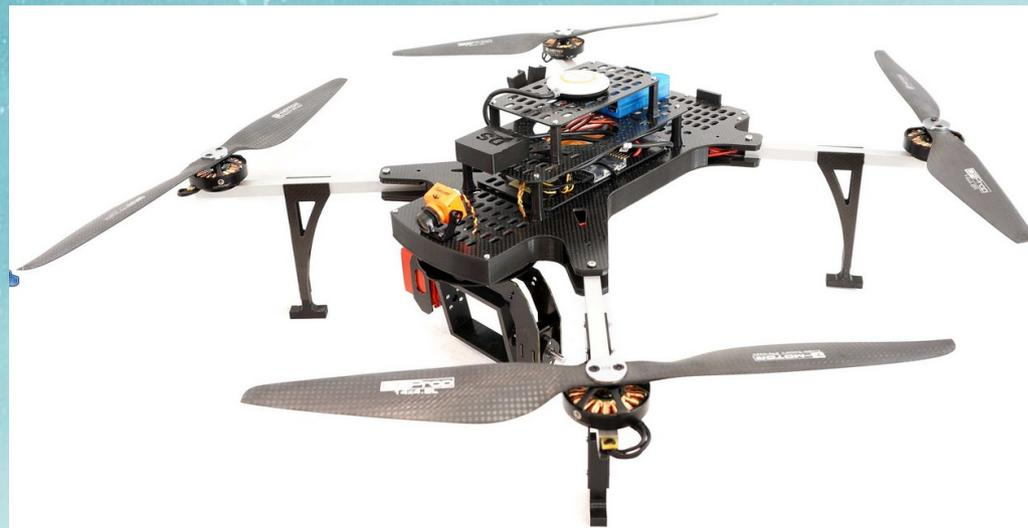
Для контроля плотности и прозрачности атмосферы будет использован вспомогательный БПЛА квадрокоптер с датчиками давления, температуры, влажности и лазерным лидаром.
