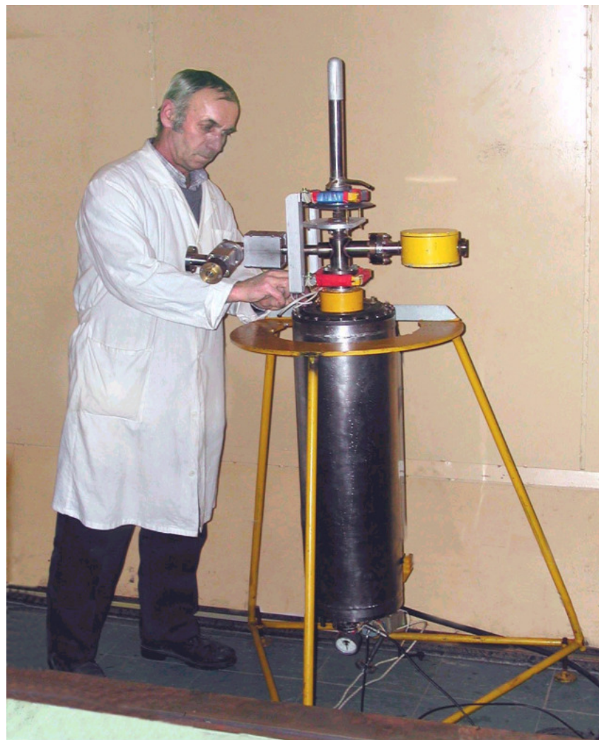
Источник рентгеновского излучения для компьютерной томографии и оперативного контроля положения пациента. ( U = 150 \text{ kV} , I = 10 \text{ mA} )
