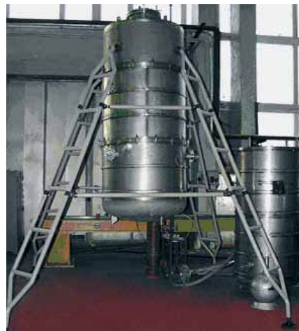
Рис. 5. Большой гелиевый вакуумный теплообменник КВУ 21-го канала.
