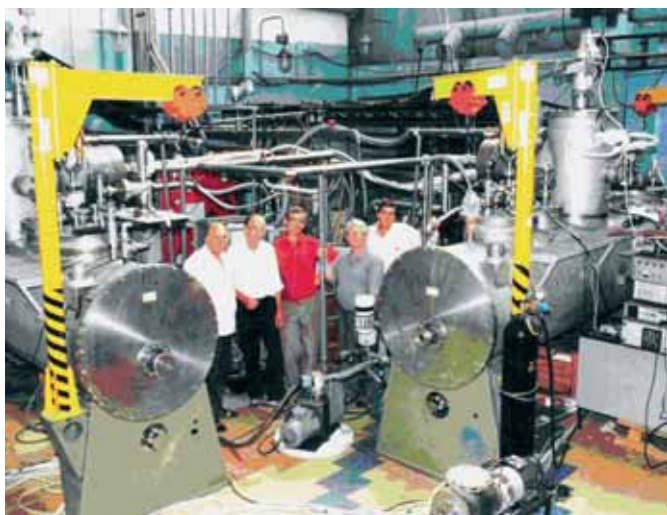
Рис. 2. Криогенный стенд для испытания сверхпроводящих СВЧ-резонаторов в зд. 33А.
